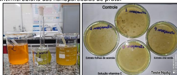
Figura 1. Soluções redutoras e placas para avaliação da atividade antimicrobiana das nanopartículas de prata.
